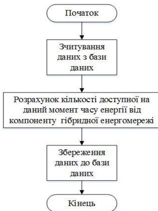
Рисунок 3.5 – Алгоритм визначення доступної на даний момент енергії від кожного з компонентів ГЕ
